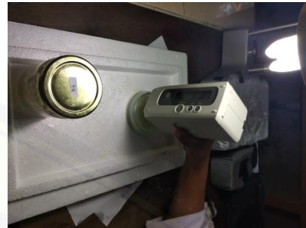
Pengujian warna menggunakan colour reader
