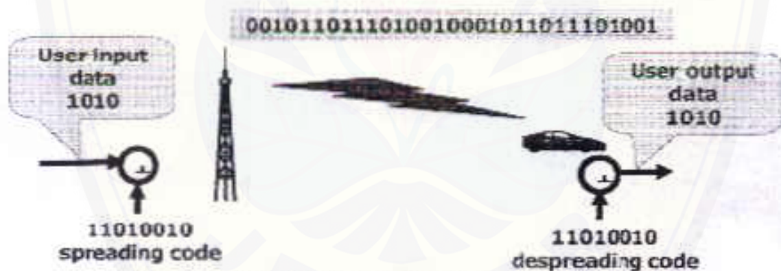
gb. 2.7 spreading dan despreading kode pada setiap panggilan sistem CDMA ( http://www.Telkom.com )
