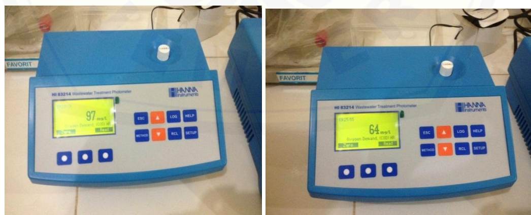
H.6 Pengukuran COD limbah cair peternakan hari ke 0 dan limbah tampungan setelah 3 hari
