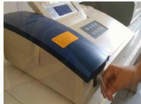
Pengecekan kadar glukosa, kolesterol total dan trigliserida darah menggunakan fotometer
