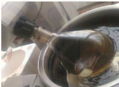
Proses pemekatan ekstrak menggunakan rotary evaporator
