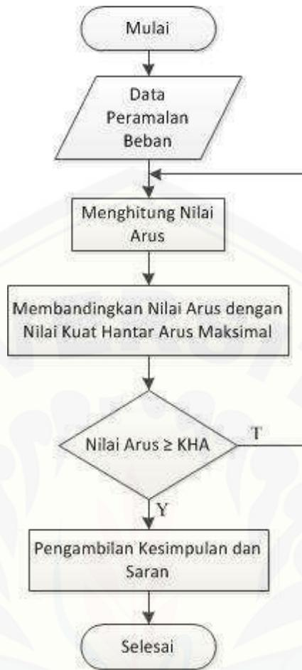
Gambar 3.3 Diagram Alir Perhitungan
