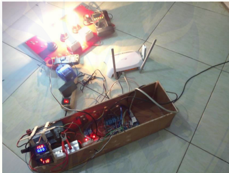
Gambar 8. Uji karakteristik pemakaian baterai penyimpanan
