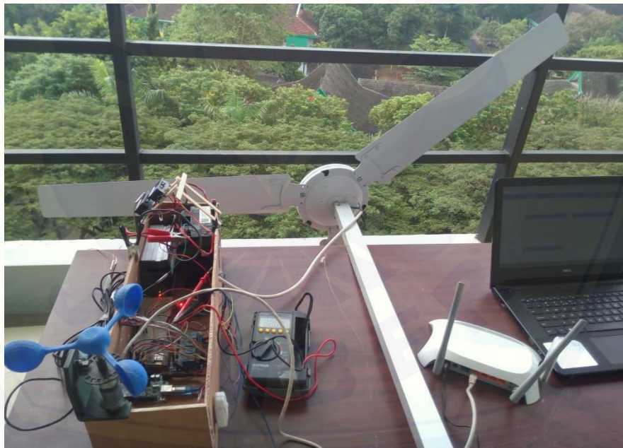
Gambar 11. Pengukuran Arus dan Tegangan baterai tanpa beban
