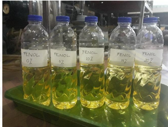
Gambar 3.2 Kondisi sampel uji murni dan variasi fenol
