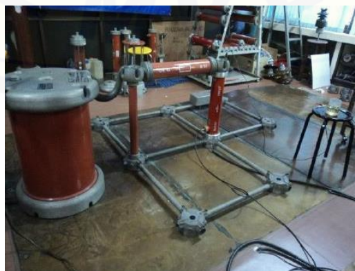
Gambar 3.7 Rangkaian pengujian tegangan tembus
