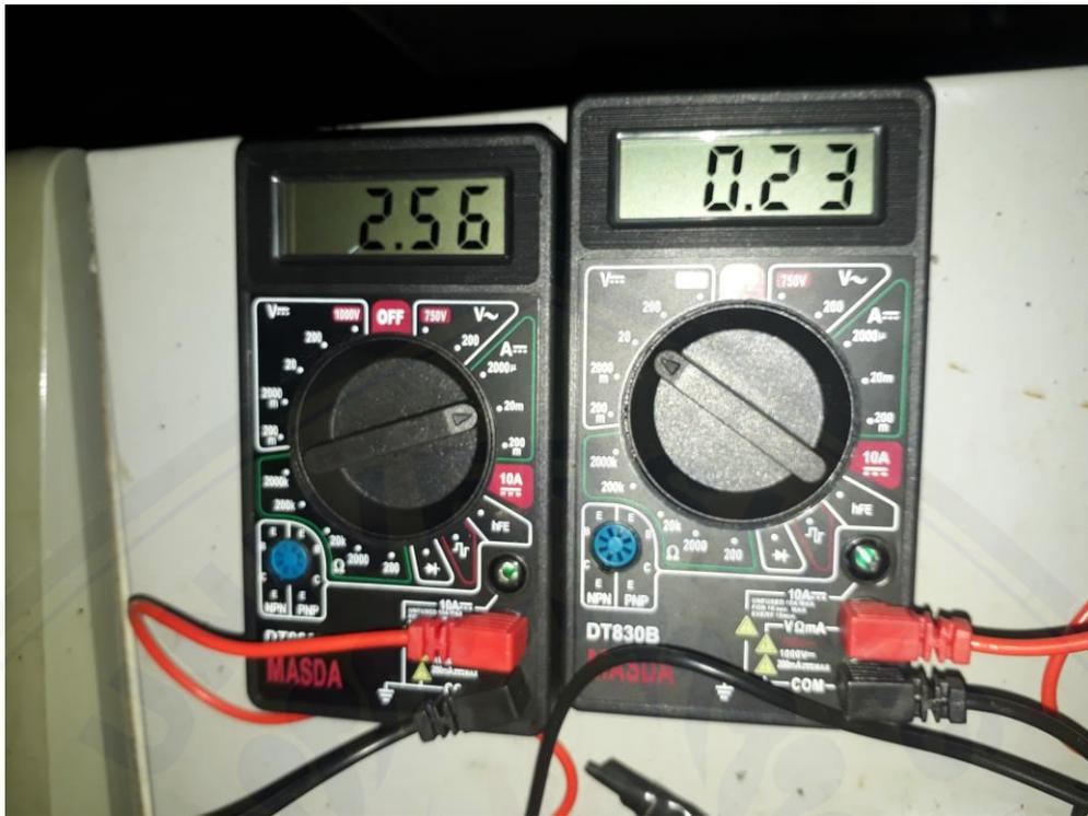
Gambar H. 5 Penggunaan dua buah multimeter untuk mengukur arus dan tegangan
