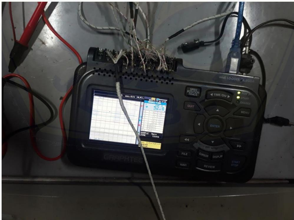
Gambar H. 4 Penggunaan *data logger* untuk pengukuran keseluruhan temperatur
