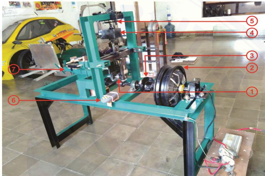
Gambar 2.17 Alat uji rolling resistance (Kurniawan, 2017)
