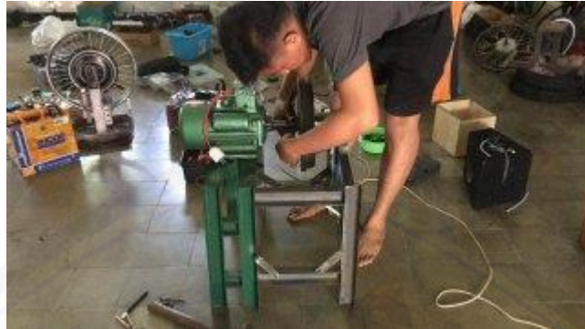
Gambar D.1 Proses assembly alat uji rolling resistance untuk bearing
