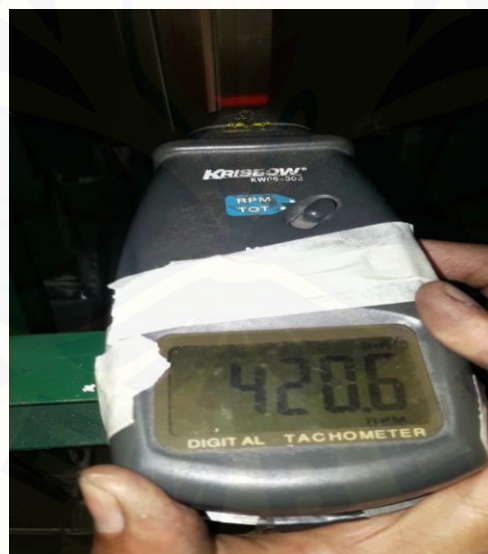
Gambar 3. 5 Pengukuran kecepatan putar bearing
