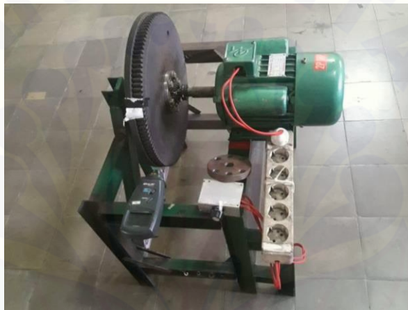
Gambar D.2 Alat uji rolling resistance untuk bearing
