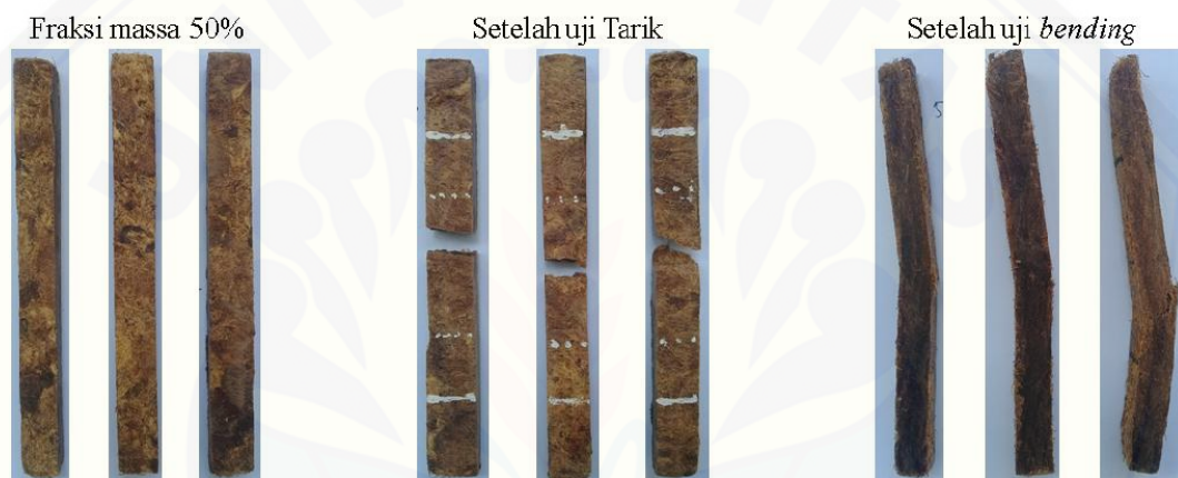
Gambar 5. Bahan Komposit fraksi massa serat 50%
