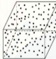
Gambar 2.4. Komposit berpenguat partikel (Sumber: Spinger, 2003)
