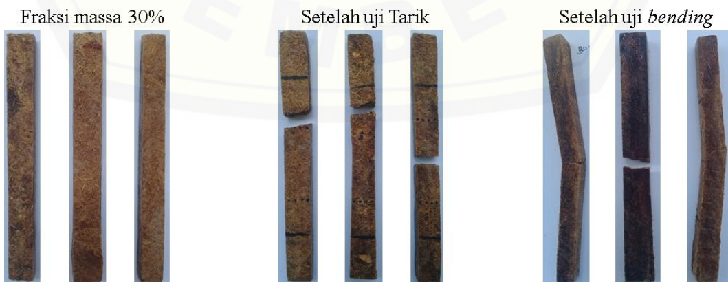
Gambar 3. Bahan komposit fraksi massa serat 30%
