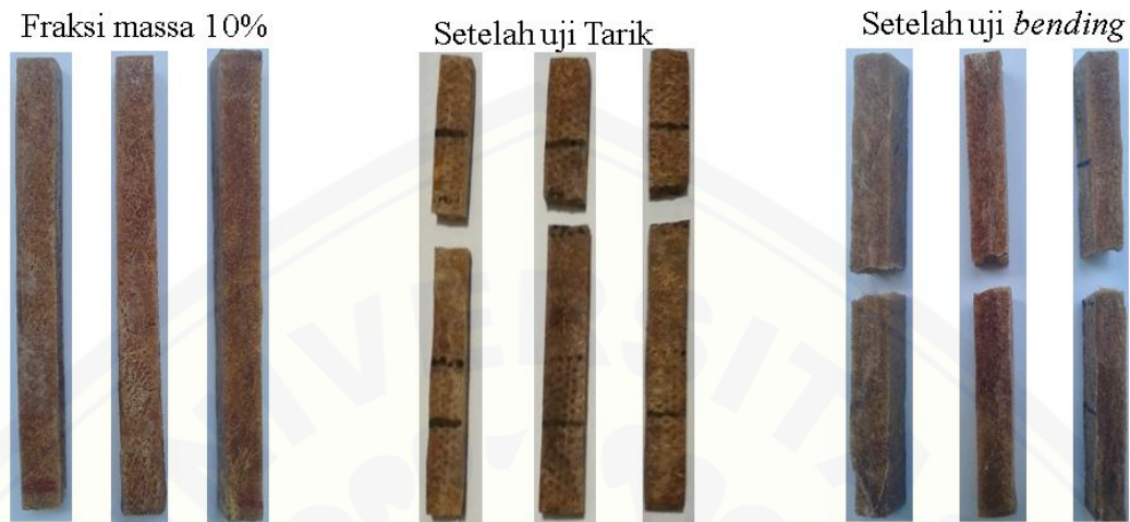
Gambar 1. Bahan komposit fraksi massa serat 10%
