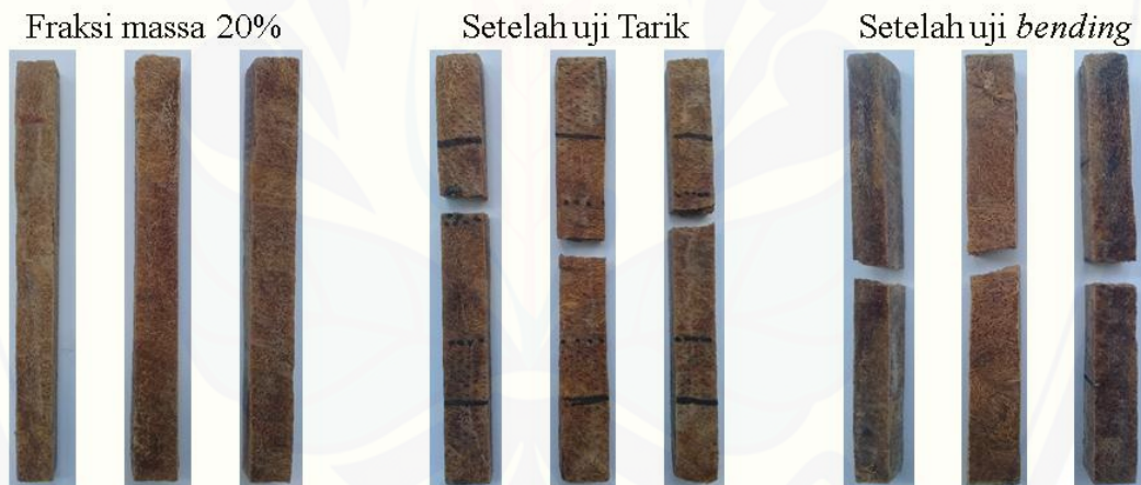
Gambar 2. Bahan komposit fraksi massa serat 20%
