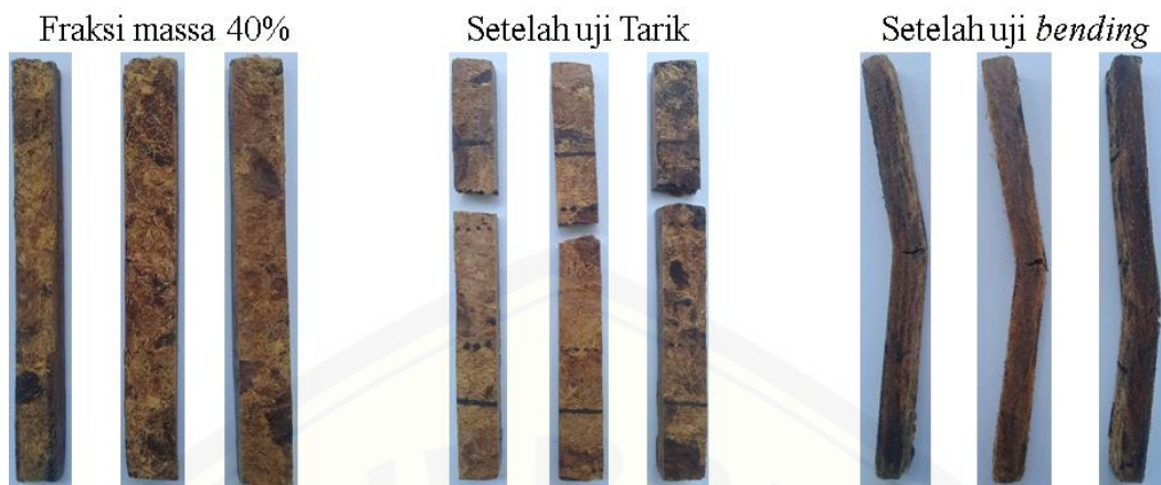
Gambar 4. Bahan komposit fraksi massa serat 40%
