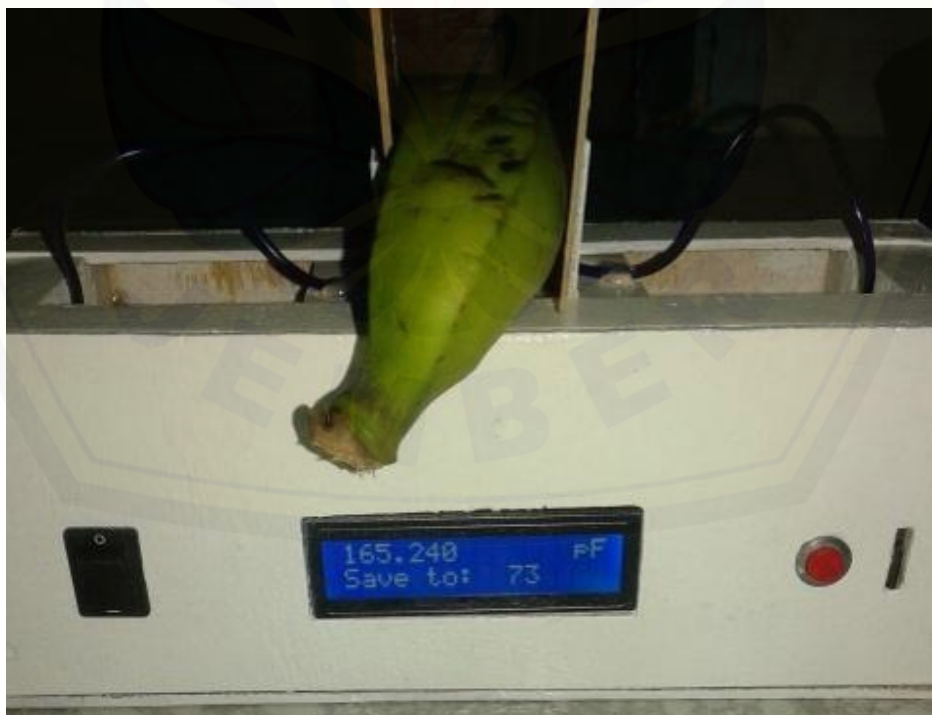
Gambar F.8 Pengukuran nilai kapasitansi buah pisang susu
