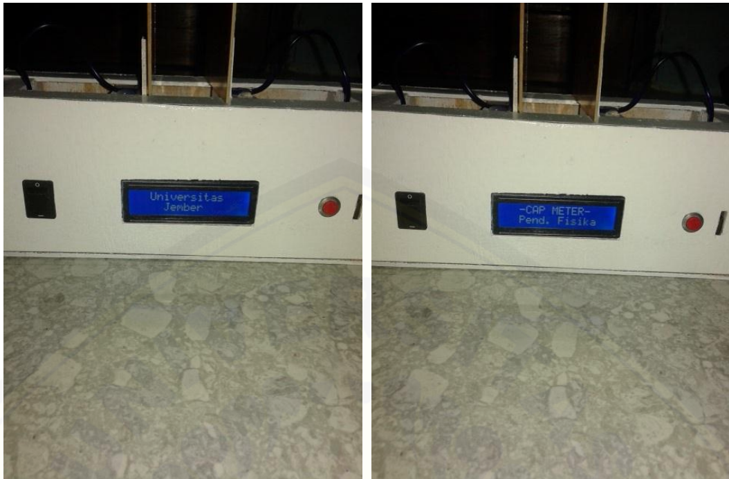
Gambar F.3 Pengujian LCD sistem alat kapasitansi meter berbasis Arduino
