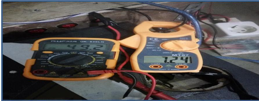
Gambar 12. Pengambilan data tegangan dan arus transformator pada sisi sekunder
