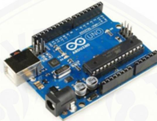
Gambar 2.19 Bentuk Fisik Arduino Uno R3 ( [www.Arduino.cc](http://www.Arduino.cc) )
