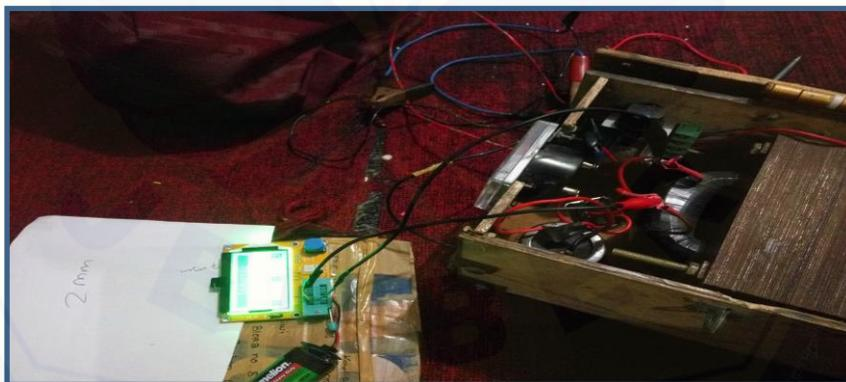
Gambar 11. Pengambilan Data Resistansi dan Induktansi
