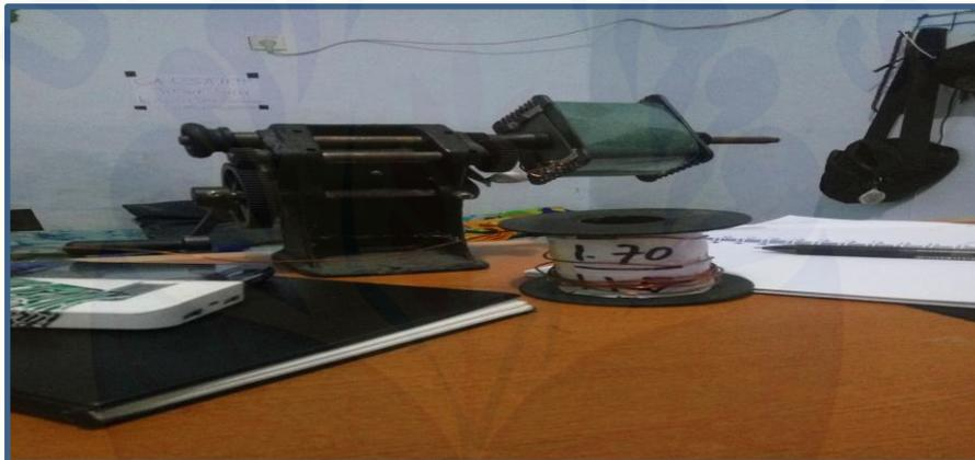
Gambar 7. Pelapisan Sisi Primer dengan Sekunder Transformator dengan Kertas Parafin
