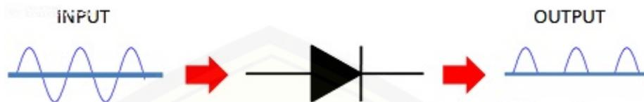
Gambar 2.13 Hasil Input dan Output Rectifier
