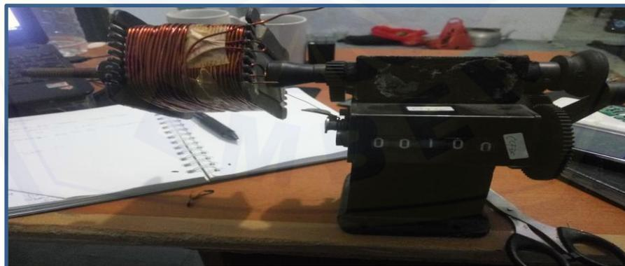
Gambar 5. Hasil Lilitan pada Transformator Sisi Sekunder
