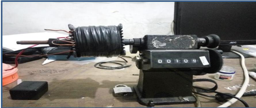
Gambar 6. Pelapisan Sisi Primer dengan Sekunder Transformator dengan Isolasi National Tape
