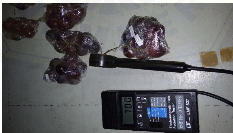
Gambar C.3 Pemberian paparan medan magnet dengan intensitas sebesar 700 \mu\text{T}
