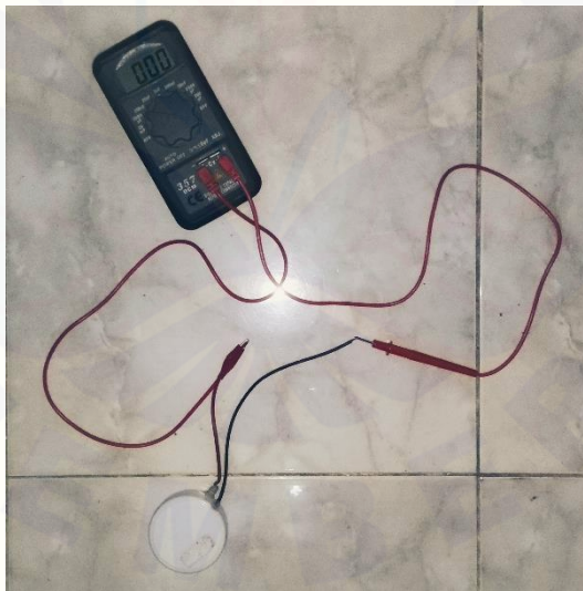
Gambar 3.5 Rangkaian alat pengukur kapasitansi
