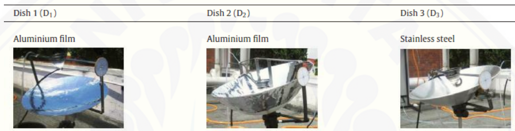
Gambar 2.12 Dish Parabolic Concentrator yang digunakan pada penelitian (Rafeeu et al. ,2012)
