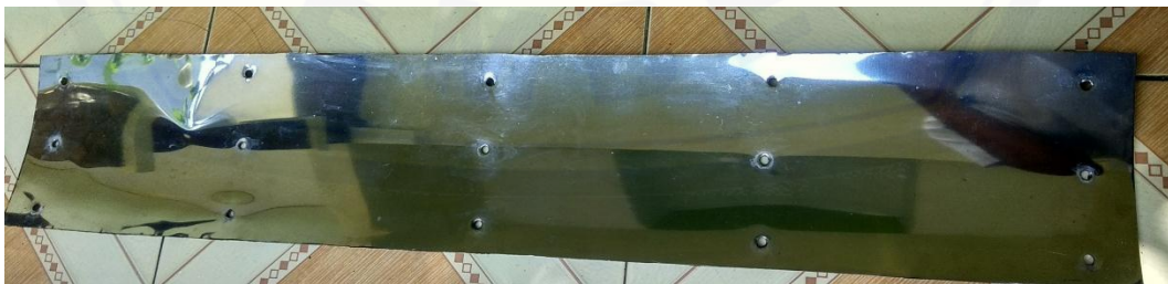
Gambar Lampiran b). Pengeboran plat diameter 0,5cm
