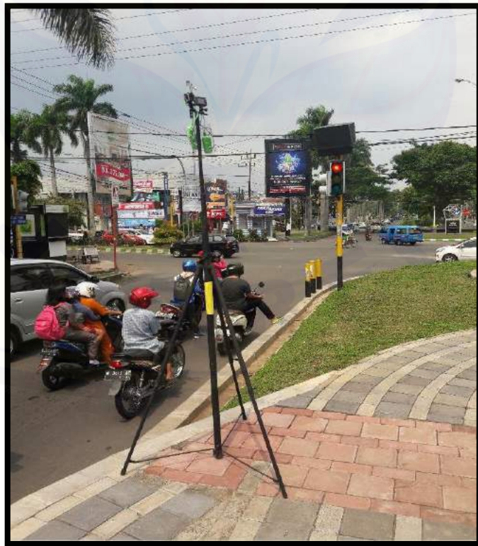
Pemasangan kamera pada pendekat JL. Terusan Dieng
