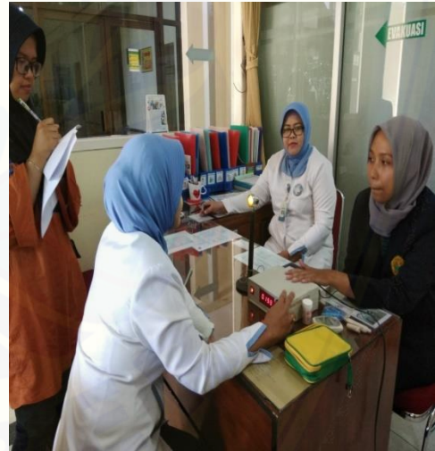
Gambar 8. Pengukuran kelelahan kerja menggunakan alat reaction timer
