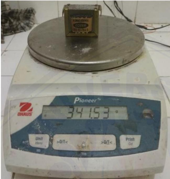
Gambar A.1. Pengukuran Timbangan Digital Ohaus Pioneer PA 2202
