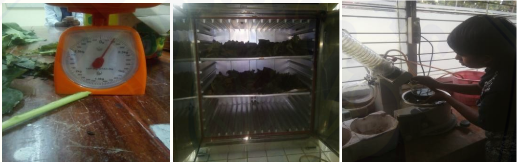
Gambar 2. (A) Penimbangan daun pepaya, (B) pengovenan daun pepaya, (C) Proses evaporasi menggunakan Rotary Evaporator
