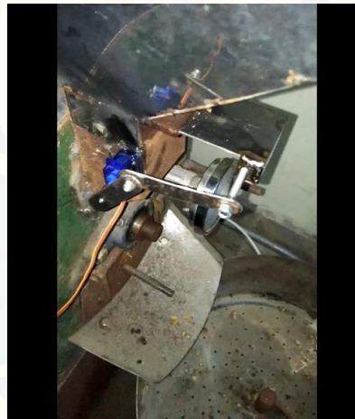
Gambar 14. Proses Membuka slider hopper setelah sensor suhu dipanaskan (uji coba mesin)
