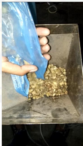
Gambar 12. Tahap pengisian (uji coba mesin)
