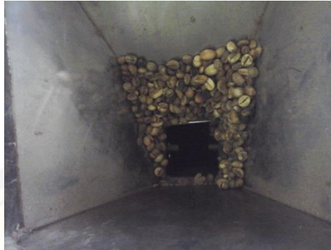
Gambar 10. Sisa biji kopi pada hopper setelah slider tutup dibuka
