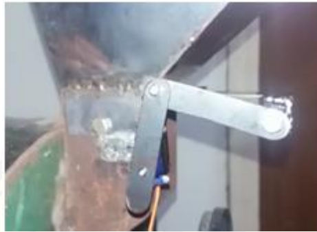
Gambar 4. Pintu hopper dengan 2 batang penghubung menggunakan motor servo
