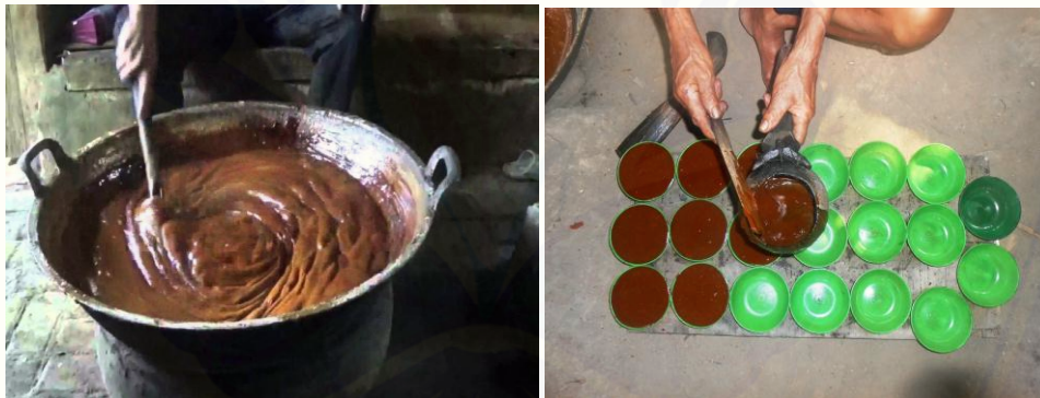
Gambar 4.7 Pendinginan Nira Pekat (kiri), Proses Pencetakan (kanan)
