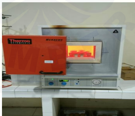
Gambar 3.2 Pembakaran abu dalam alat furnace bersuhu 900 0 C (Sumber: Koleksi Pribadi, 2017).
