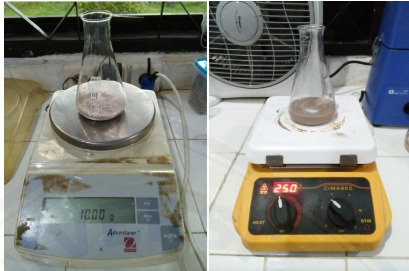
Gambar 3.7 Pengadukan campuran bahan menggunakan alat pengaduk magnet (Sumber: Koleksi Pribadi, 2017).
