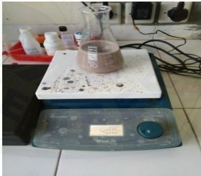
Gambar 3.4 Pengadukan campuran bahan menggunakan alat pengaduk magnet (Sumber: Koleksi Pribadi, 2017).
