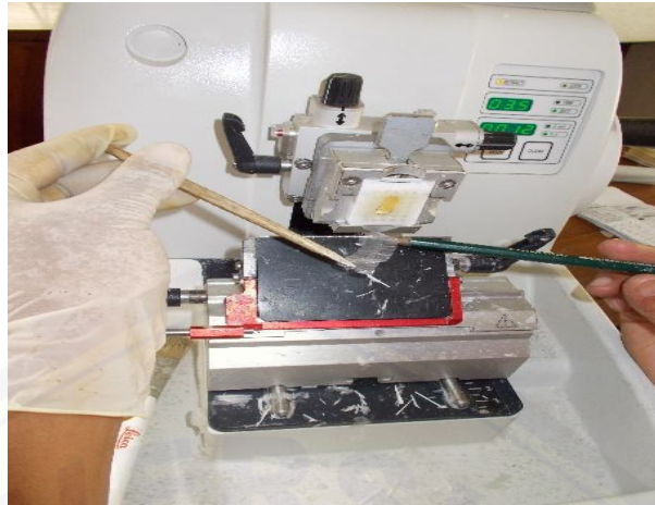
Gambar 3.26 Penayatan menggunakan mikrotom (Sumber : Koleksi Pribadi, 2017)
