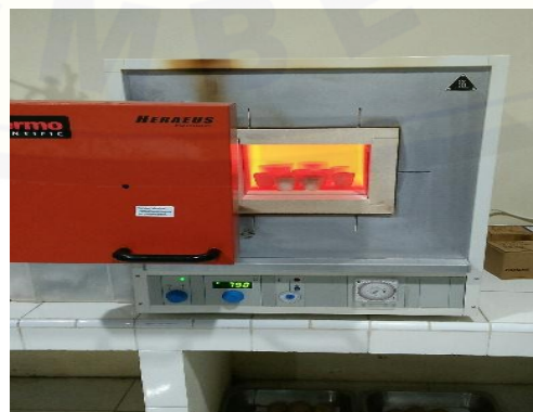
Gambar 3.12 Pengeringan tahap akhir dengan alat furnace bersuhu 600-1000^{\circ}\text{C} (Sumber: Koleksi Pribadi, 2017).
