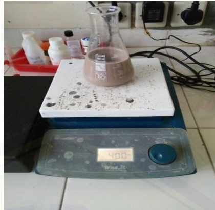
Gambar 3.10 Pengadukan campuran bahan menggunakan alat pengaduk magnet (Sumber: Koleksi Pribadi, 2017).
