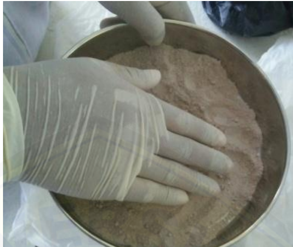
Gambar 3.3 Mengayak abu ampas tebu dengan ayakan 200 mesh (Sumber: Koleksi Pribadi, 2017).
