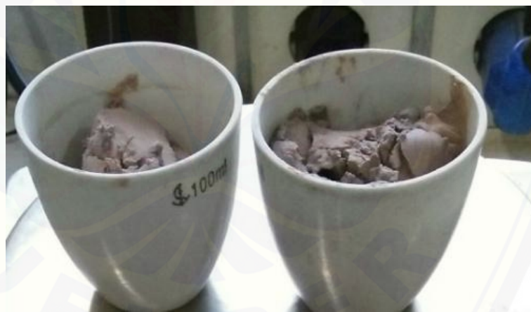
Gambar 3.8 Hasil penyaringan berupa natrium sillicat basah (Sumber: Koleksi Pribadi, 2017).
