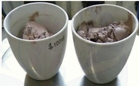
Gambar 3.11 Hasil pengadukan campuran bahan yang dipindah ke cawan porselen (Sumber: Koleksi Pribadi, 2017).
