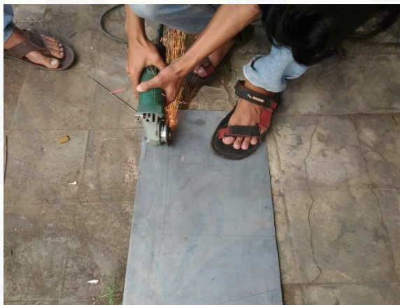
Gambar C.2 Pemotongan Bahan Untuk Tempat Tatakan
