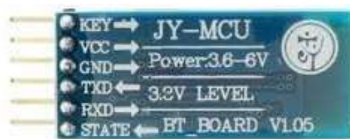
Gambar 2.12 Konfigurasi Pin Modul Bluetooth HC-05 (Sumber: eprints.polsri.ac.id)
