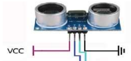
Gambar 2.7 Tampilan Sensor ultrasonik HC-SR04 (Sumber: Setiawan dkk, 2014)
