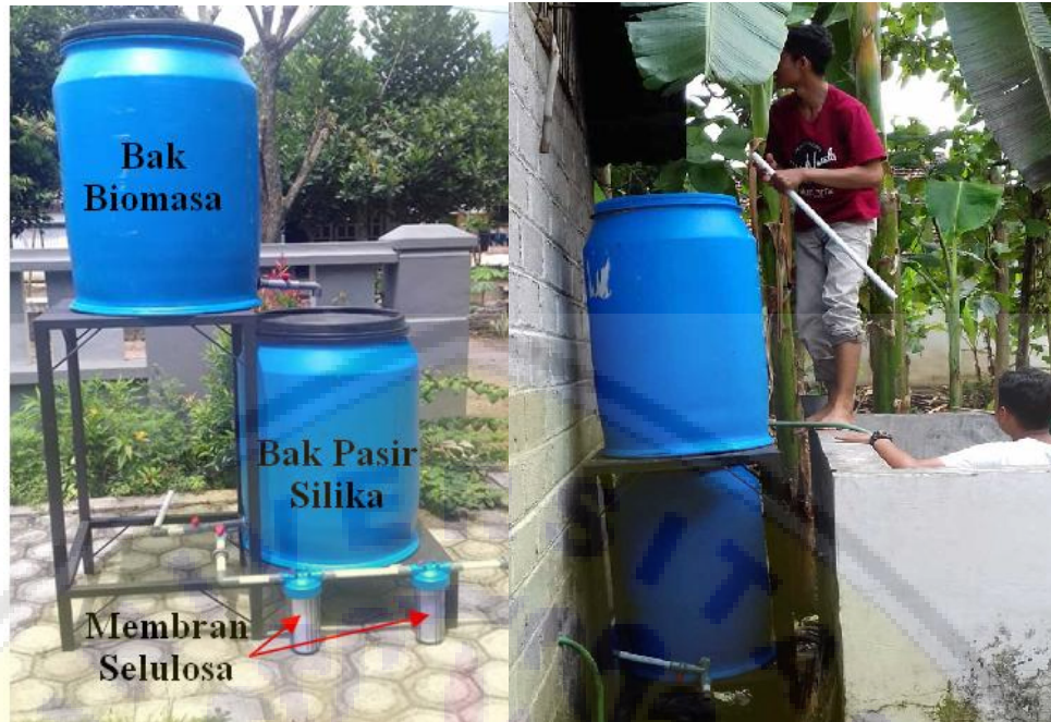
Gambar 1. Desain dan Instalasi sistem penyaringan air limbah produksi tahu sederhana menggunakan membran
