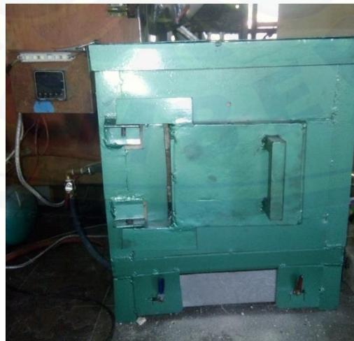
Gambar D.15 Alat Dapur Pemanas (*Muffle Furnace*) tampak depan
