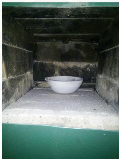
Gambar D.20 Peletakkan kowi pada ruang bakar dapur pemanas
