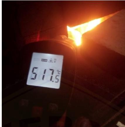
Gambar D.10 Proses pengecekan pemanas menggunakan *Thermogun*
