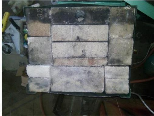
Gambar D.18 Penataan dapur pemanas (*muffle furnace*) tampak atas
