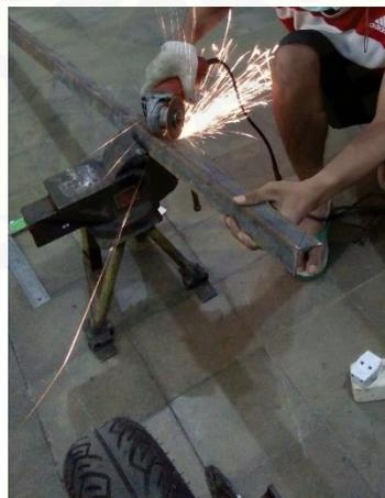
Gambar D.3 Pemotongan bahan (ST-37)
