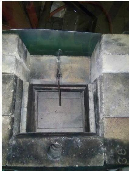
Gambar D.19 Peletakkan termokopel pada ruang bakar dapur pemanas
