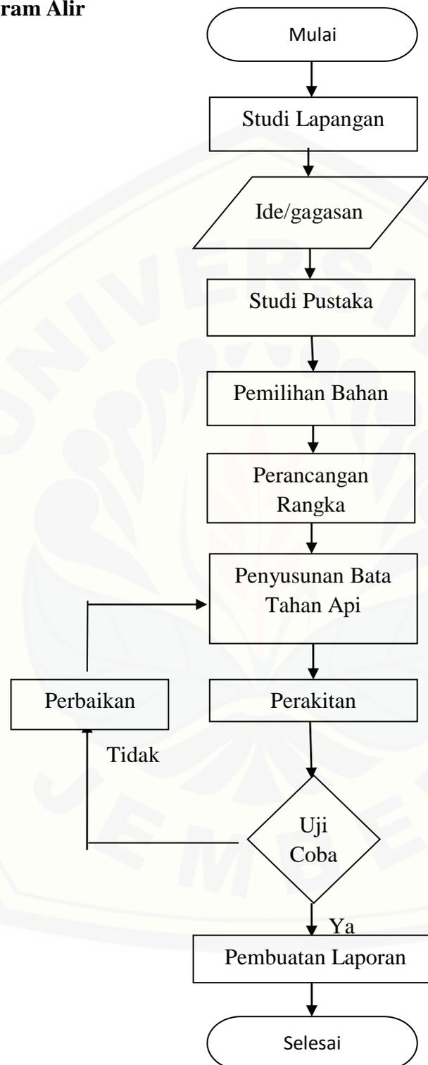
Gambar 3.2 Diagram Alir rancang bangun dapur pemanas (*muffle furnace*) menggunakan bahan bakar gas LPG
