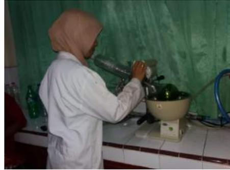
b) *Evaporatory* untuk membuat filtrat menjadi ekstrak dengan suhu  $50^{\circ}\text{C}$
