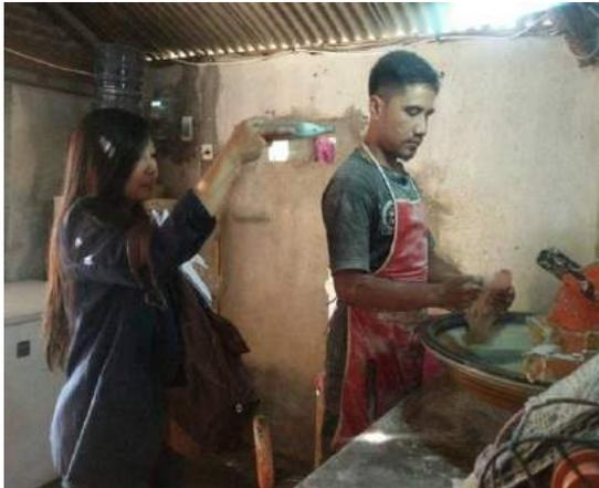
Gambar 1. Pengukuran intensitas kebisingan pada pekerja
