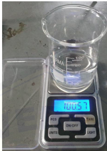
Gambar 4.4.3 Pengukuran massa larutan sukrosa
