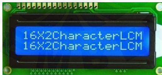
Gambar 2.4. Bentuk Fisik LCD 16x2 (Sumber : http://www.boarduino.web.id/2014/12/ )
