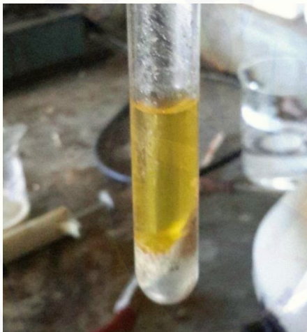
Hasil sentrifugasi menghasilkan 3 lapisan (minyak ikan, lemak dan air)
