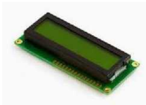
Gambar 2.4 Bentuk fisik LCD 16 x 2 ( http://baskarapunya.blogspot.com )
