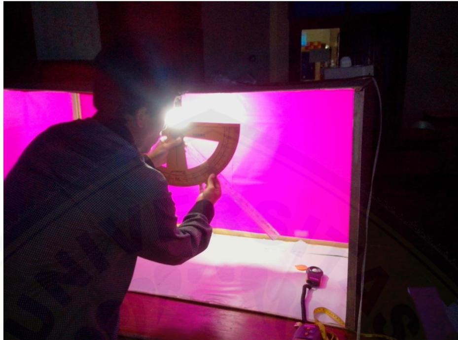
Gambar 3. Pengukuran sudut dari lampu terhadap sensor
