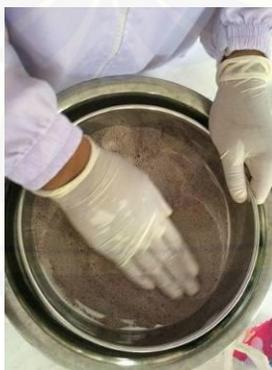
Gambar 3. 2 Mengayak abu ampas tebu menggunakan ayakan 200 mesh
