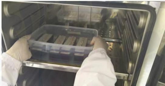
Gambar 3.14 Merendam sampel di dalam wadah berisi akuades steril dan dimasukkan dalam inkubator suhu  $37^{\circ}\text{C}$  (Sumber: Koleksi pribadi)
