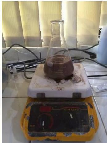
Gambar 3.3 Pencampuran abu ampas tebu dengan HCL menggunakan alat pengaduk magnet (Sumber: Koleksi pribadi)
