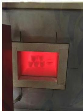
Gambar 3.1 Pembakaran abu dalam alat *furnace* bersuhu  $900^{\circ}\text{C}$
