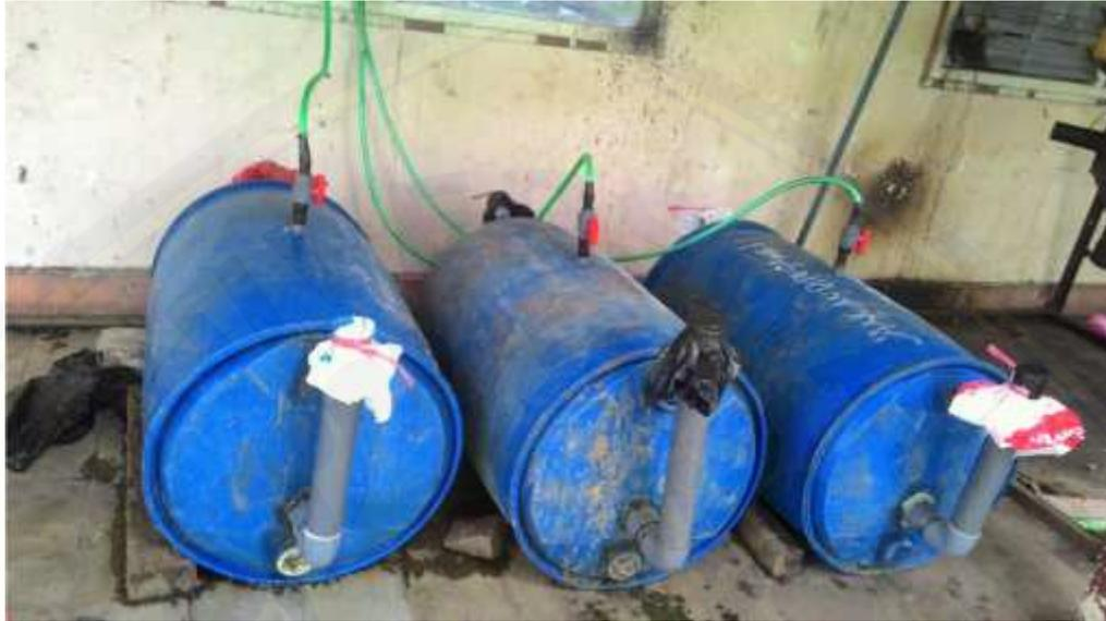
Gambar B.1 Reaktor Biogas
