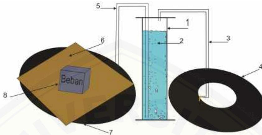
Gambar 3.3 Skema pemurnian biogas
