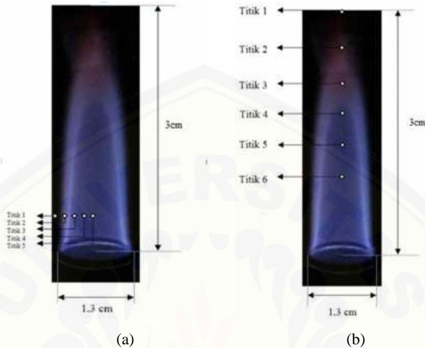
Gambar 3.6 Contoh pengambilan data temperatur secara
