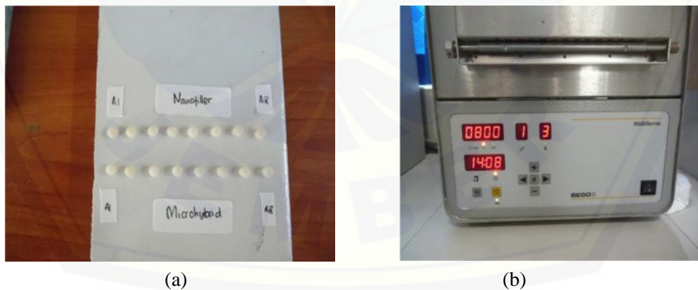
Gambar 3.7 (a) Kelompok sampel resin komposit nanofiller (A3) dan resin komposit microhybrid (B3) (b) Pemanasan hingga suhu 800°C
