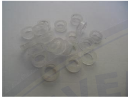
Pembuatan cetakan sampel dari syringe insulin
