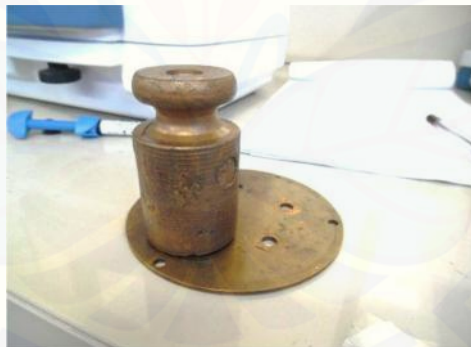
Gambar 3.3 Cetakan yang terisi ditimpa dengan anak timbangan seberat 1 kg.
