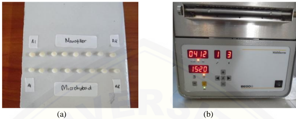
Gambar 3.6 (a) Kelompok sampel resin komposit nanofiller (A2) dan resin komposit microhybrid (B2) (b) Pemanasan hingga suhu 412°C
