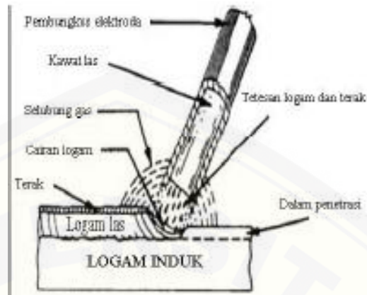
Gambar 2.10 Ilustrasi las SMAW (Sumber : Pujo dan Sarjito, 2008)
