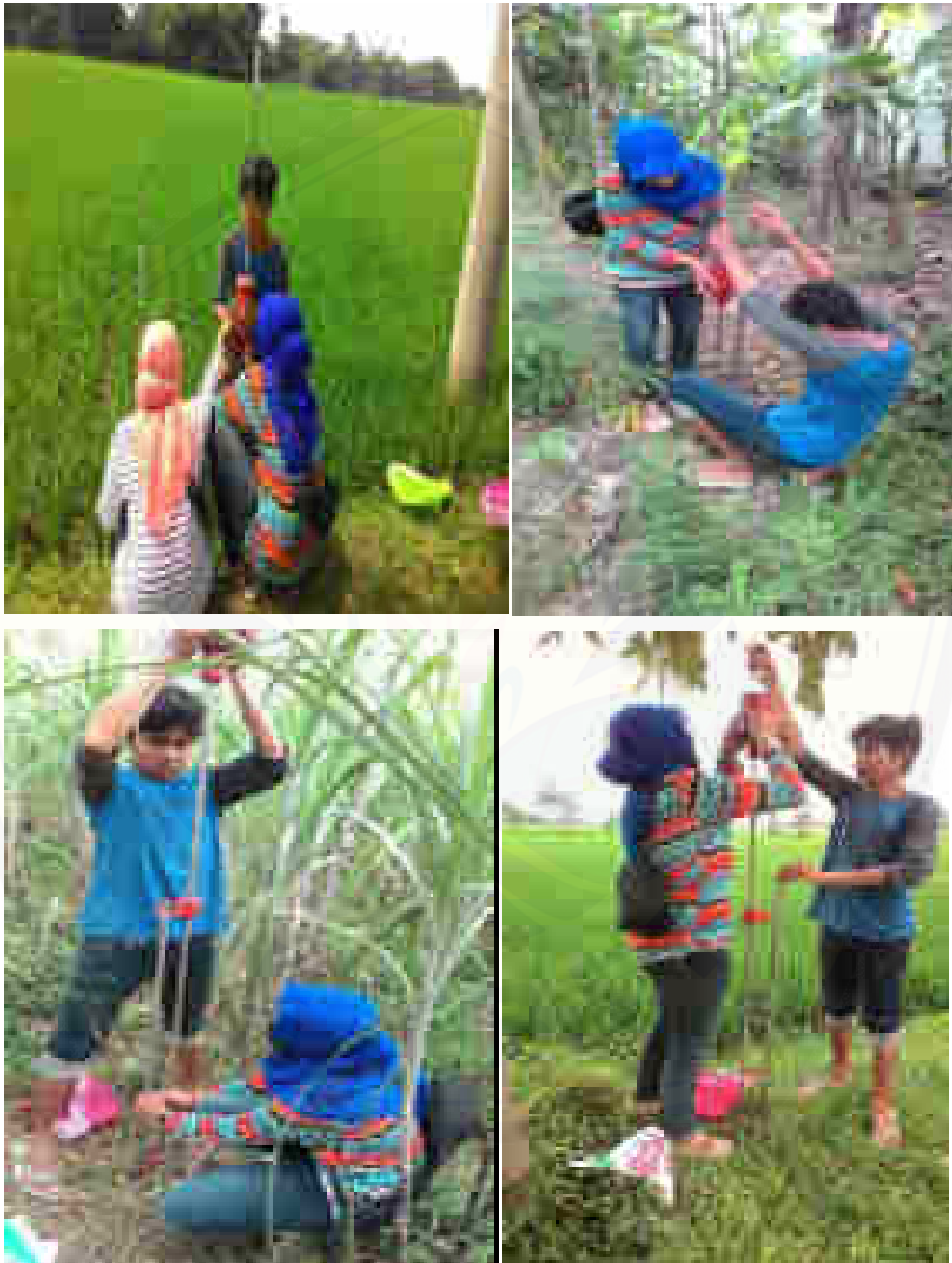
Gambar B.2 pengambilan data CBR tanah dasar hari 2
