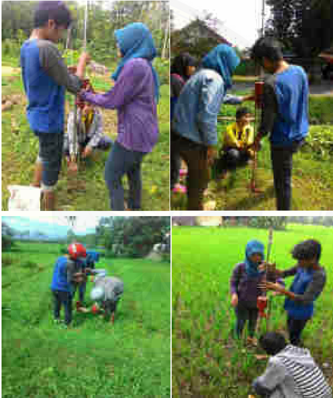
Gambar B.1 pengambilan data CBR tanah dasar hari 1
