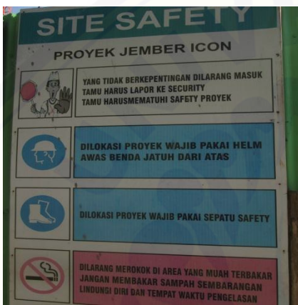
Rambu-Rambu Keselamatan dan Kesehatan Kerja di area Proyek
