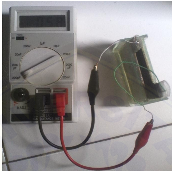
Gambar F.4 Pengukuran kapasitansi dengan kapasitansimeter untuk menentukan kapasitor rangkaian
