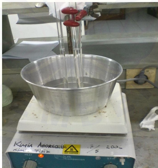
Gambar F.3 Pengukuran waktu alir sampel dengan viskometer Ostwald
