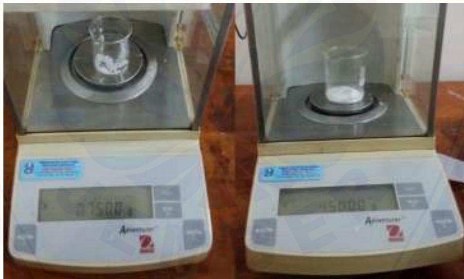
Proses penimbangan bahan aktif (metfomin hidroklorida) dan polimer (etil selulosa) menggunakan timbangan analytic digital
