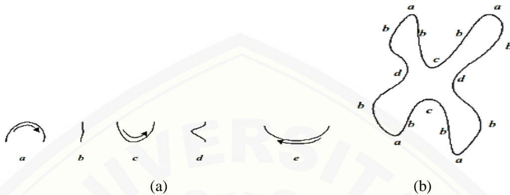
(a) Pola Dasar Grammar Kromosom; (b) Pengodean Kromosom Gambar 2.3 Contoh Pengenalan Pola Sintaksis (Sumber: Munir, 2004:235)
