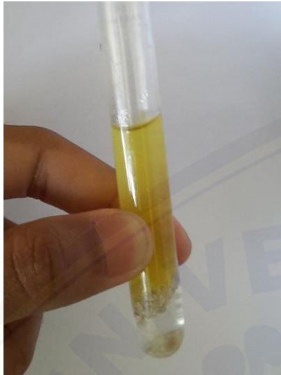
Hasil sentrifugasi menghasilkan 3 lapisan (minyak ikan, lemak dan air)
