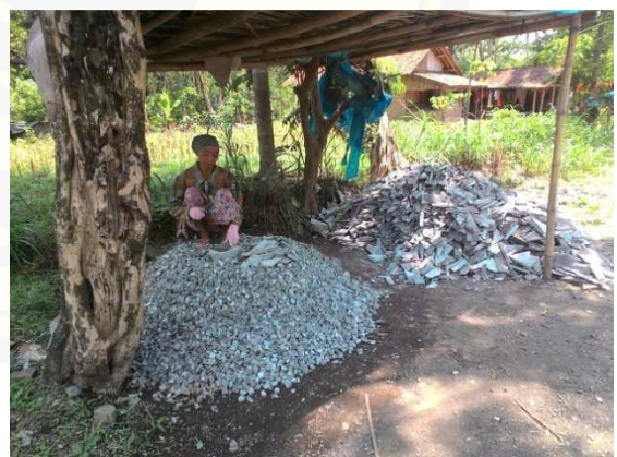
Gambar 12. Pekerja Sedang bekerja memecah batu
