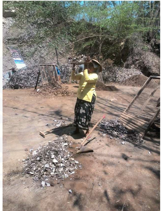
Gambar 16. Pekerja mengangkat keranjang batu untuk dipindahkan ke tempat pemecahan batu
