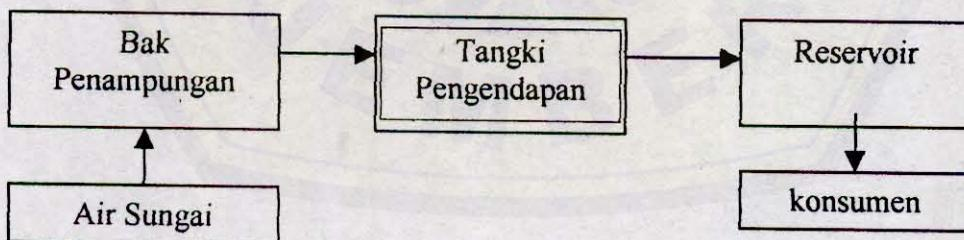
Gambar. 3 : Proses Produksi untuk Air Sungai
