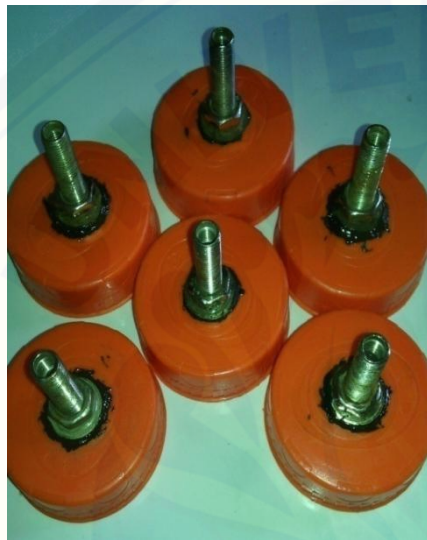
Gambar 3.4 pengeboran dan pemasangan dob
