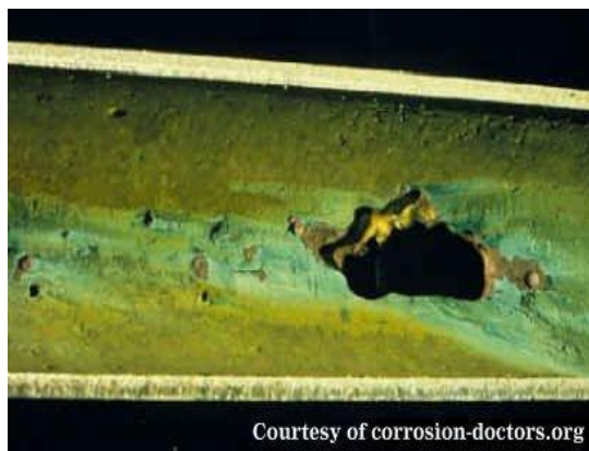
Gambar 2.6 Korosi Erosi (Sumber: Utomo, 2009)
