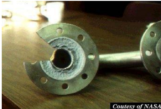
Gambar 2.3 Korosi Celah (Sumber: Utomo, 2009)
