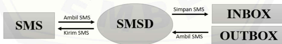
Gambar 2.3 Diagram Blok GAMMU (Sumber: Hasil Analisis, 2015)
