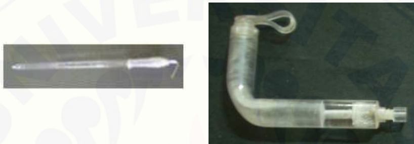
Gambar 3.2 Kontruksi Mikroelektroda dan Elektroda Wick
