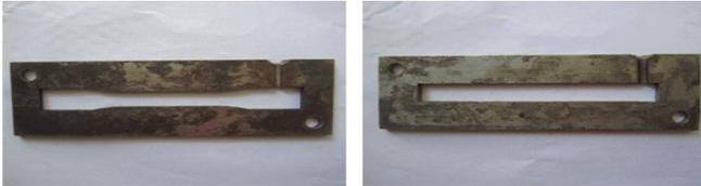
Gambar 1. Profil cetakan uji tarik dan *bending*
