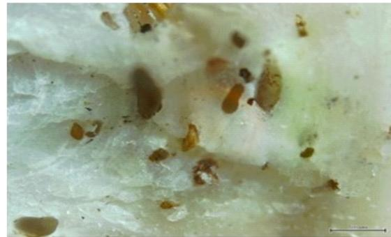
Gambar 10. Foto mikroskopis perbesaran 40x daerah patahan spesimen uji tarik serat 2 mm
