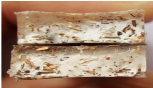
Gambar 9. Foto makroskopis daerah patahan spesimen uji *bending* dengan serat 2 mm
