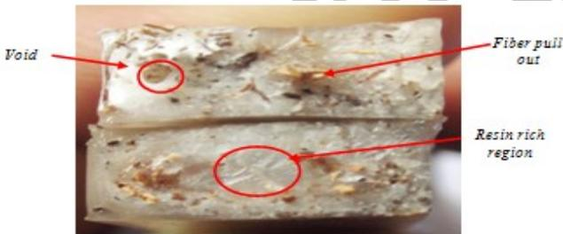
Gambar 8. Foto makroskopis daerah patahan spesimen uji tarik dengan serat 2 mm
