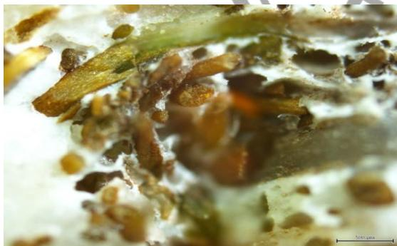
Gambar 14. Foto mikroskopis perbesaran 40x daerah patahan spesimen uji tarik serat 8 mm
