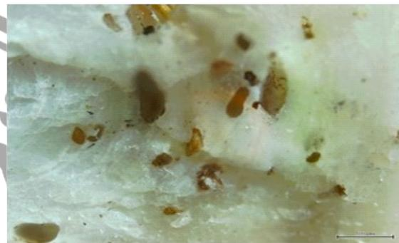
Gambar 11. Foto mikroskopis perbesaran 40x daerah patahan spesimen uji *bending* komposit serat 2 mm
