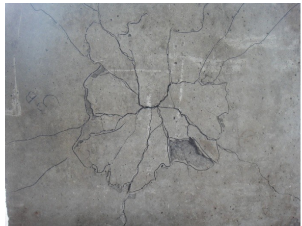
Gambar 14 Pola Keruntuhan pada Pelat 3B ( \rho = 0,006648 )
