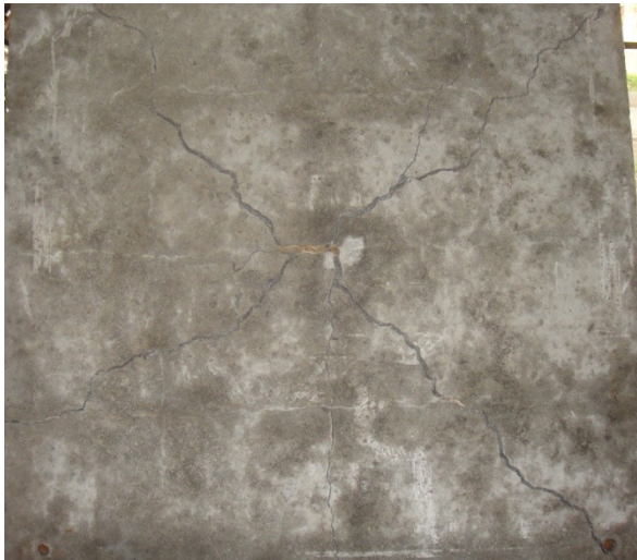
Gambar 8 Pola Keruntuhan pada Pelat 9 ( \rho = 0,00638 )
