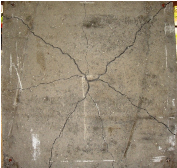
Gambar 12 Pola Keruntuhan pada Pelat 9B ( \rho = 0,002418 )
