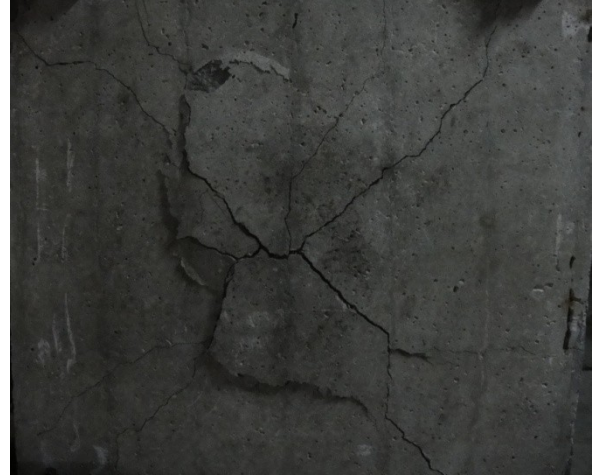
Gambar 9 Pola Keruntuhan pada Pelat 6 ( \rho = 0,00912 )
