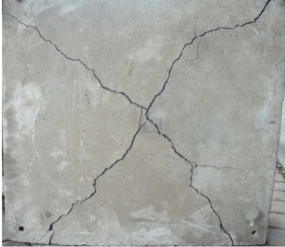
Gambar 7 Pola Keruntuhan pada Pelat 12 ( \rho = 0,00456 )
