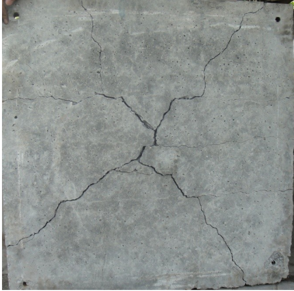
Gambar 11 Pola Keruntuhan pada Pelat 12B ( \rho = 0,001813 )
