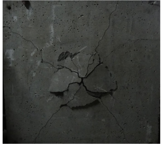
Gambar 13 Pola Keruntuhan pada Pelat 6B ( \rho = 0,003626 )
